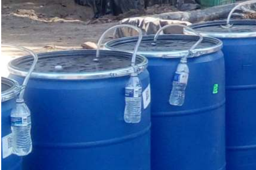
Figura. 1. Producción de biol artesanal en tambos de 200 L con sistema de desalajo de gases que son producto de la fermentación.
