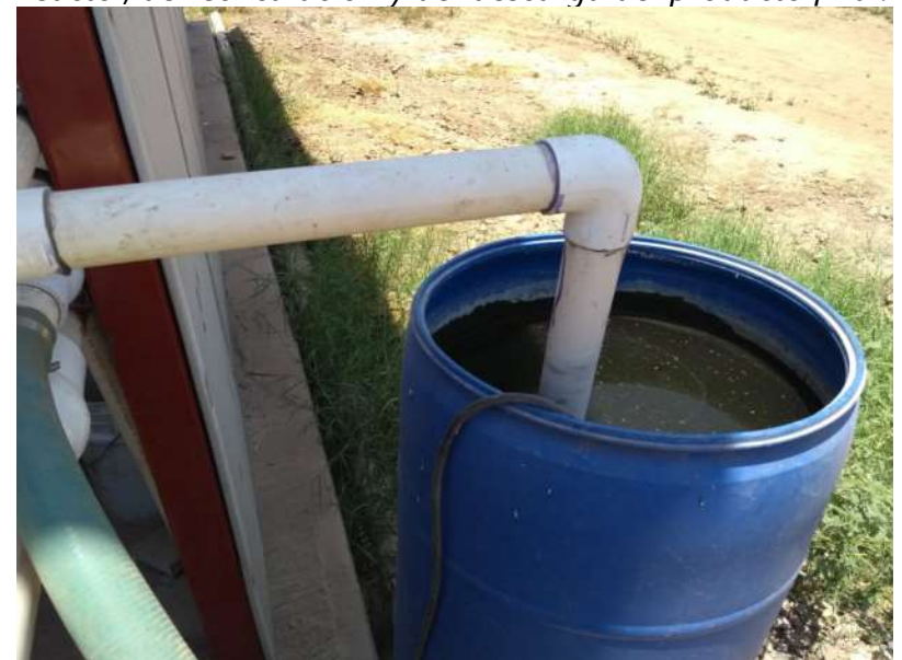
Figura. 7. Reservorio de agua para la evacuación de gases producidos durante la fermentación.
