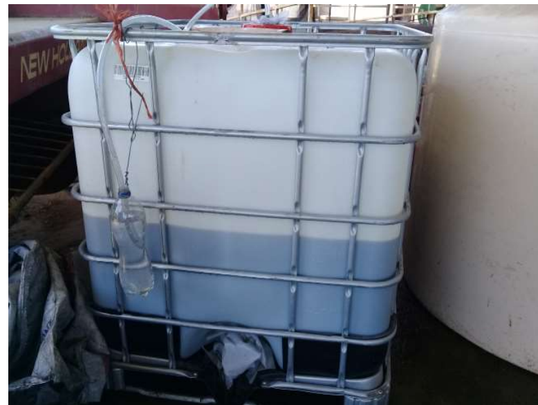
Figura. 2. Producción de biol artesanal en depósitos de 1000 L con sistema de desalojo de gases que son producto de la fermentación.
