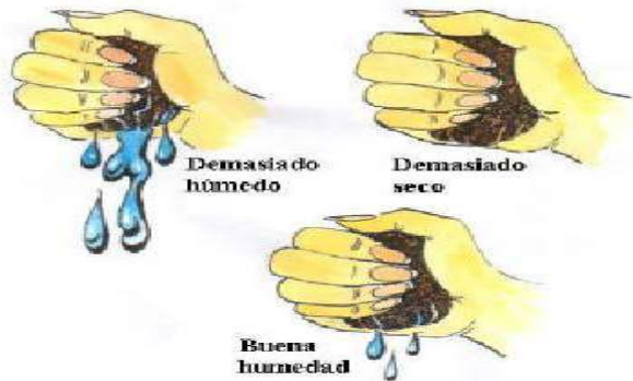
Medición de la Humedad
