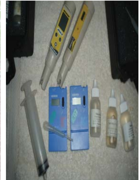
Figura 2. Equipos para determinar pH, conductividad eléctrica, potasio y nitratos en la solución del suelo.
