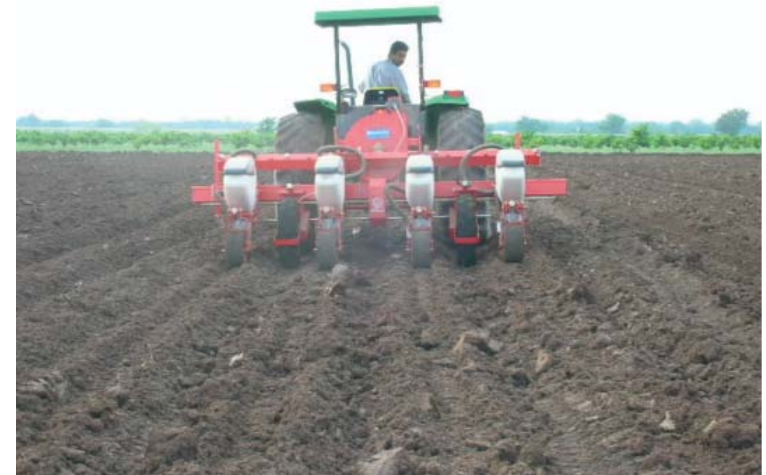
Siembra con sembradora neumática de precisión.
