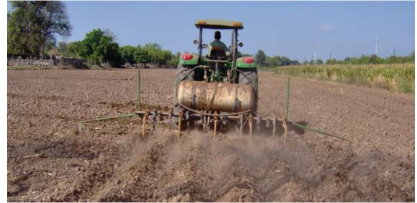
Marca de surcos y aplicación de fertilizante (gas amoníaco) en un solo paso.
