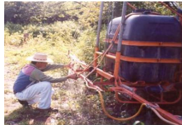
Calibración del equipo de aspersión antes de una aplicación de herbicida.
