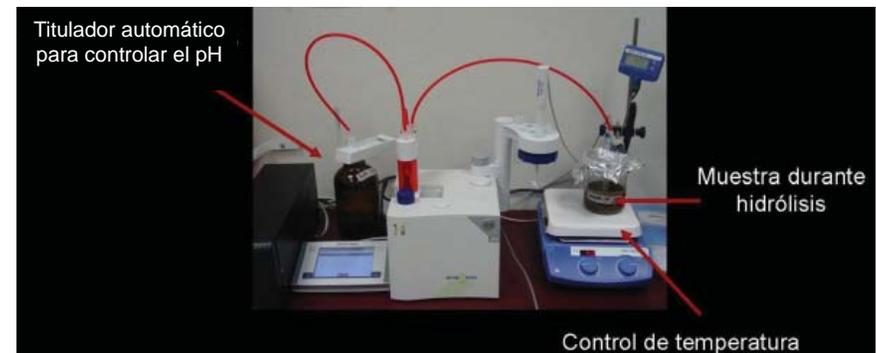
Figura 7. Sistema de hidrólisis, donde se observa el titulador automático que controla el pH de la solución y un sistema para el control de la temperatura.
