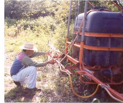
Calibración de aspersora.
