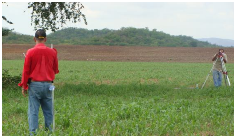
Figura 2. La mejor opción para trazar los bordos de retención de humedad son las curvas de nivel. El único inconveniente de este método es que se requiere de mayor inversión.
