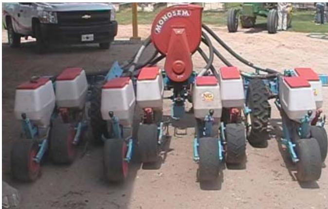
Figura 6. Sembradora de precisión para siembra en riego en primavera-verano.
