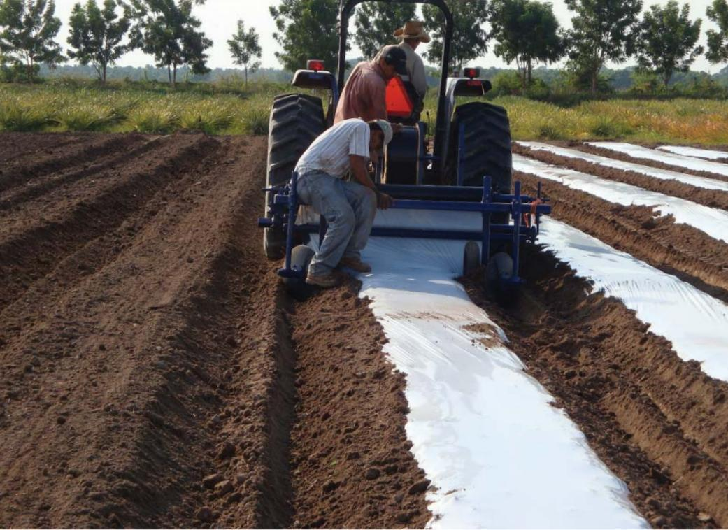
Figura 2. Acolchado y colocación cinta de riego con acolchadora.
