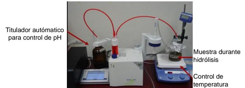
Figura 4. Sistema de hidrólisis, donde se observa el titulador automático que controla el pH de la solución y un sistema para el control de la temperatura.
